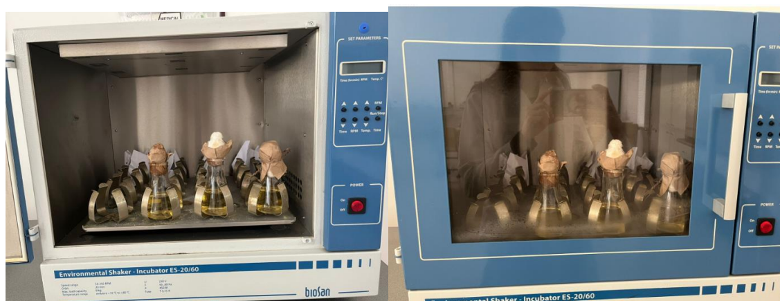
Рисунок 6 – Процесс биоферментации Aspergillus niger в шейкере инкубаторе
